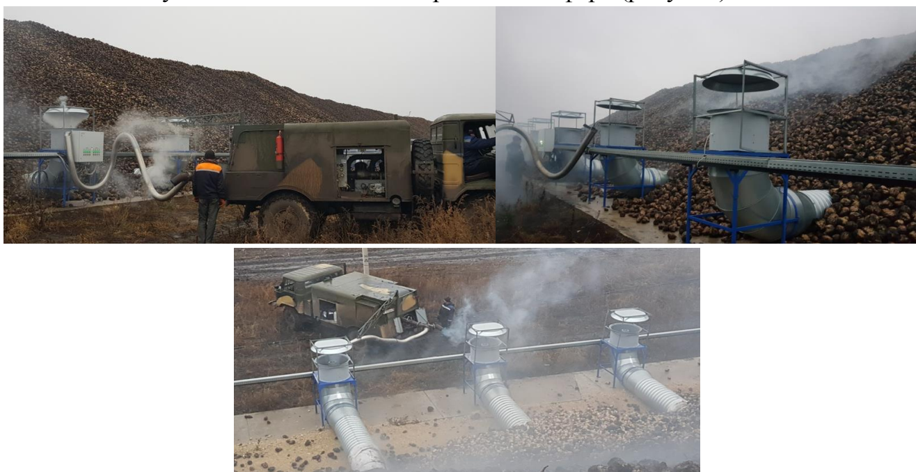
Рисунок – Обработка кагата баковой смесью препаратов «Anabios» и «Somnus» с помощью МКД
