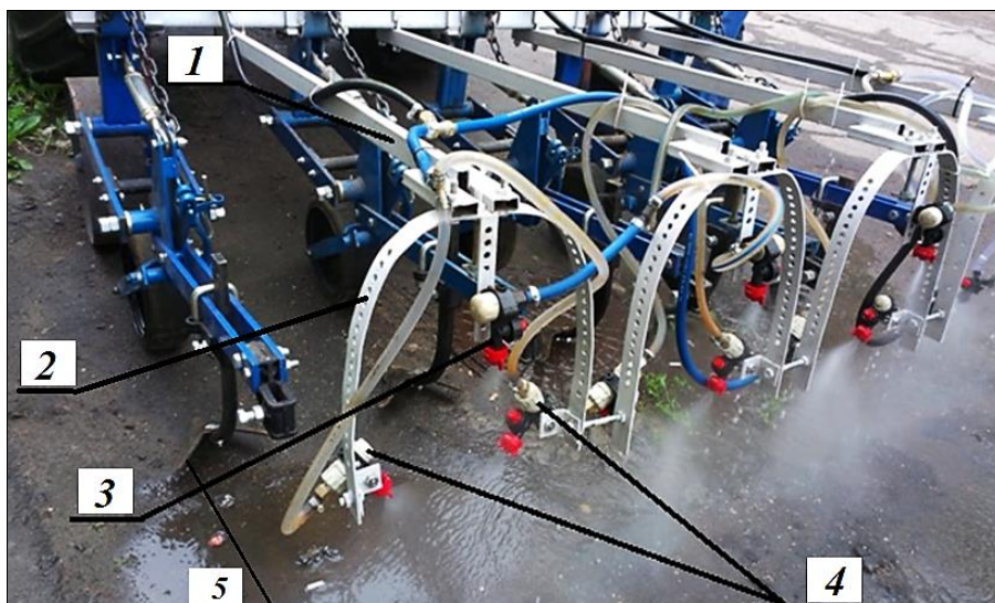
Рисунок 1 – Комбинированный агрегат для обработки подсолнечника: 1 – секция культиватора; 2 – аппликатор; 3 – верхний распылитель; 4 – боковые распылители; 5 – культиваторные лапы для механической обработки междурядий.
