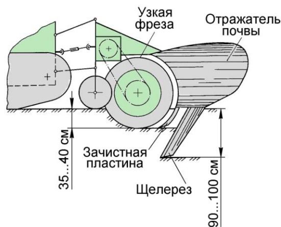
Рис. 3.2. Схема щелевателя ЩР-1
